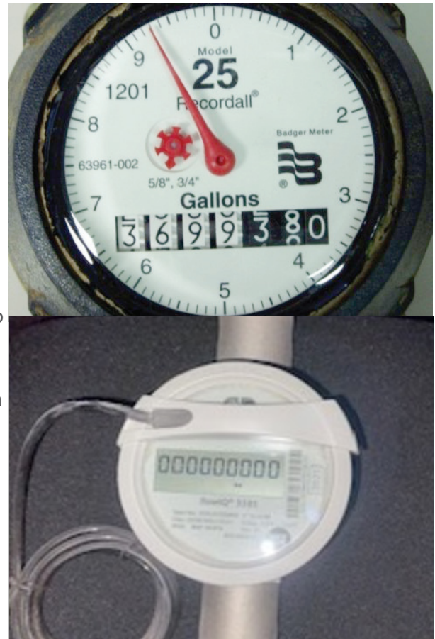
Gráfico 1-12 Medidor analógica en galones (arriba) y pies cúbicos (abajo)
