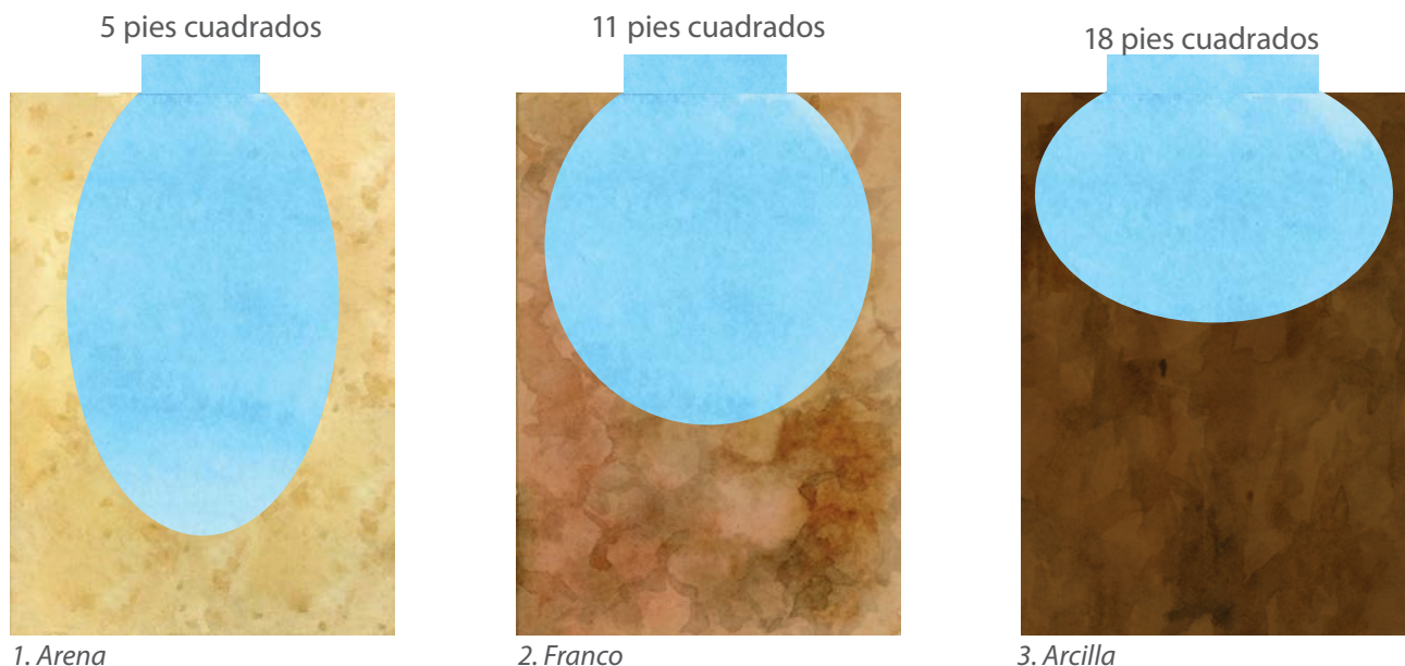
Figura 3-11: Cómo viaja el agua a través del suelo – patrones mojados producidos por un emisor de goteo
