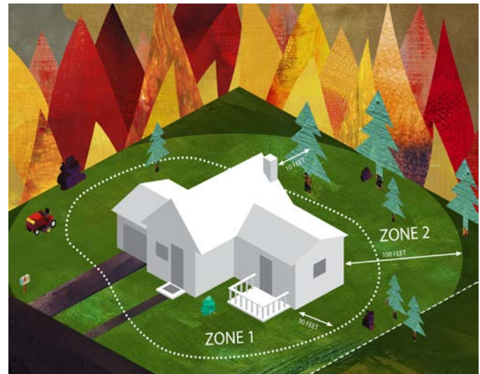
Figura 2-9: Espacios defendibles contra los incendios (La imagen es cortesía de Cal Fire www.readyforwildfire.org )
