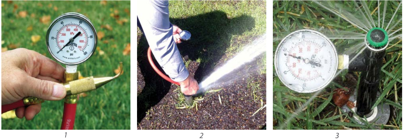
Figura 7-11: Izquierda a derecha (1) tubo pitot (2) midiendo la presión con un tubo pitot (3) manómetro ensamblado en una tee
